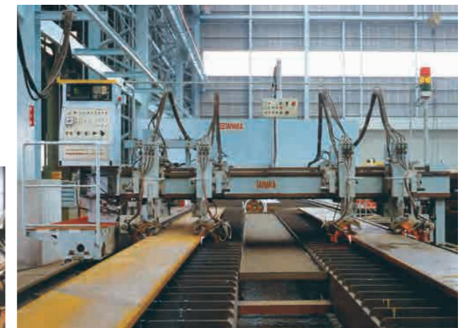
鉄骨ボックス柱スキンプレート開先加工機
